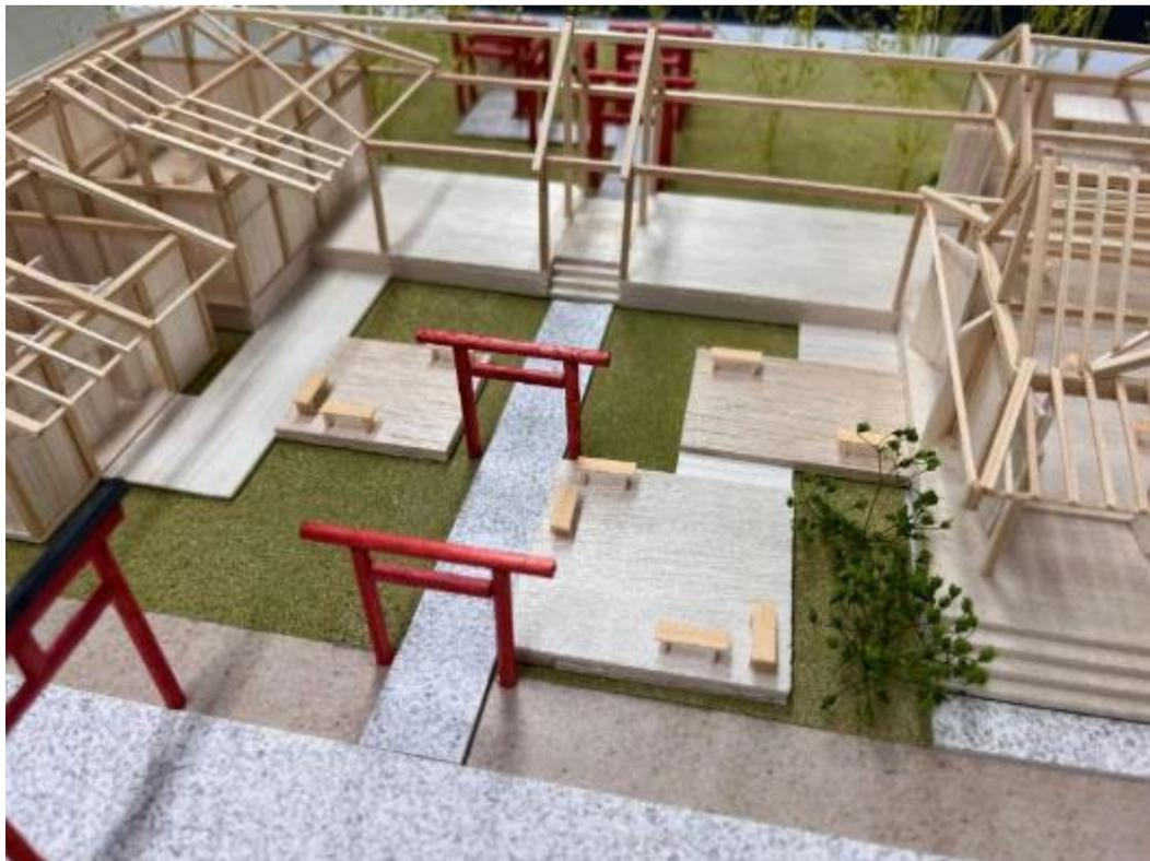
社殿と建物を渡り廊下でつなぎ、行き来しやすいようにした。渡り廊下はレベル800mm上げているため、ステージとして使用できる。奥の神社への参道を確保するため、渡り廊下内に階段がついている。
