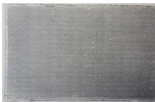
図4 唐長が金唐革紙の製造に用いた板木。弘化3年(1846) 4 。
