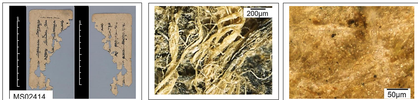
図3 中世の仏教偽経の天地八陽神呪経のウイグル訳。用紙はアシ茎紙。ごく微細粟澱粉填料がここにも使われていた
